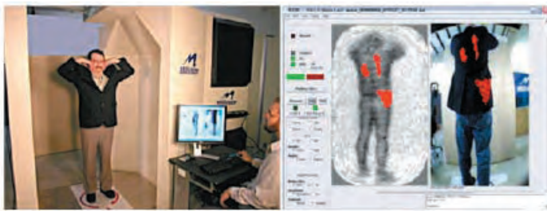
Figura 1. Escáner Millivision Portal Systems 350. A la derecha, captura de pantalla en la que el software ATD marca los objetos sospechosos.
